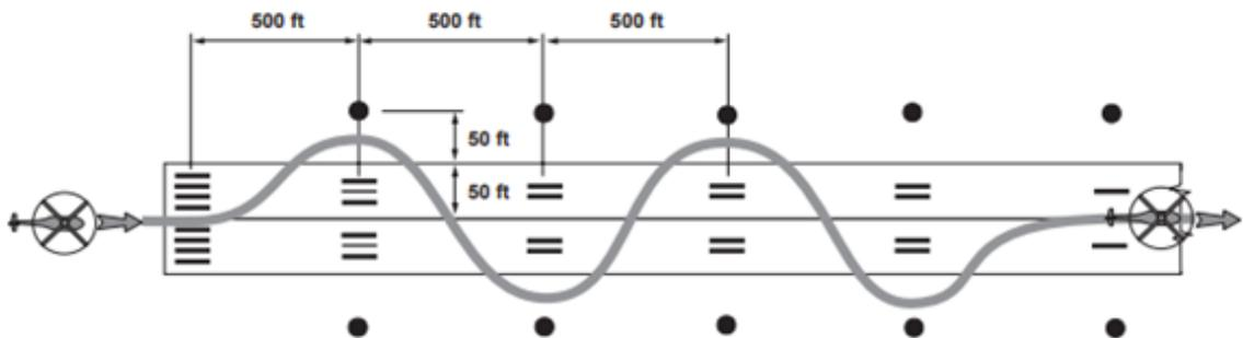
Fig. 6. Slalom manoeuvre dimensions
