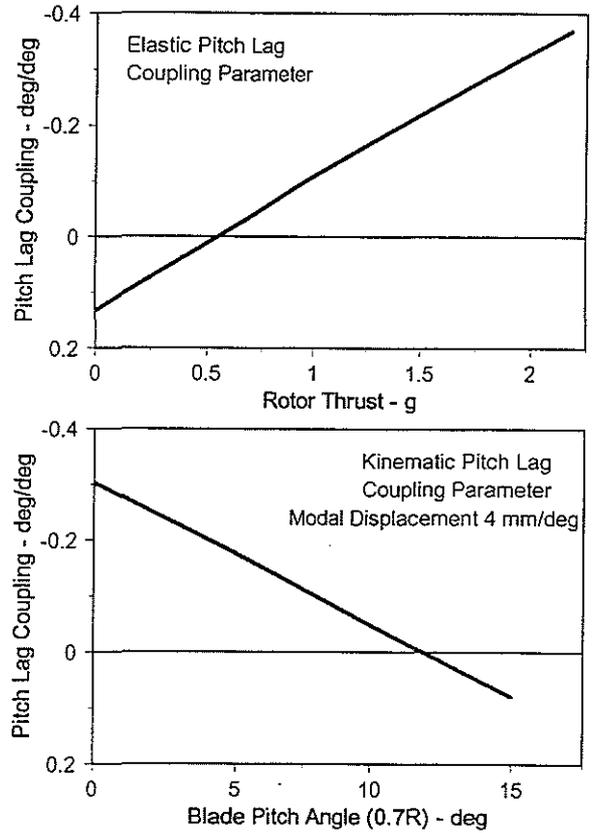
Fig. 9 Pitch lag coupling
