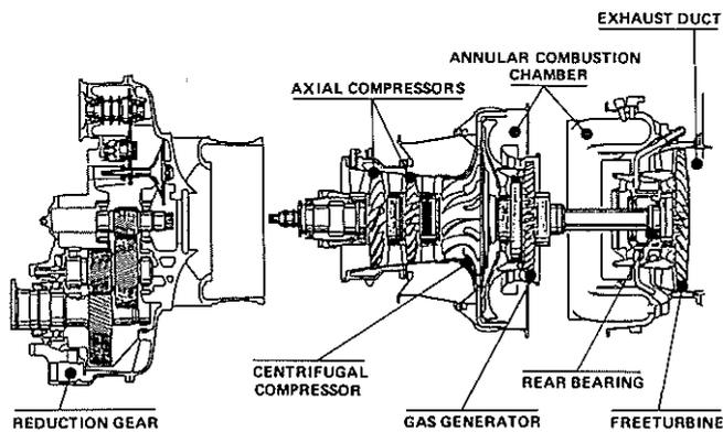
Fig. 15 : TURBOMEGA TM 333 - 1M TURBOSHAFT ENGINE
