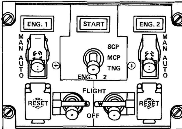
Fig. 15b : ENGINE CONTROLS PANEL ON CONSOLE
