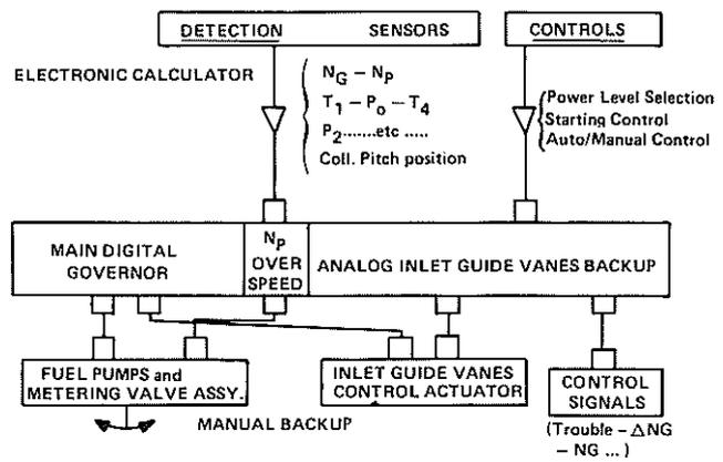
Fig. 15a : TM 333 - ENGINE FUEL CONTROL SYSTEM
