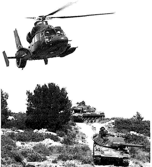
Fig. 7 : THE PANTHER IN A FIRE SUPPORT CONFIGURATION. IT IS EQUIPPED WITH BOTH A GIAT 20 mm CANNON POD ON LH SIDE AND A BRANDT 68 mm ROCKET – LAUNCHER CONTAINER ON RH SIDE.
