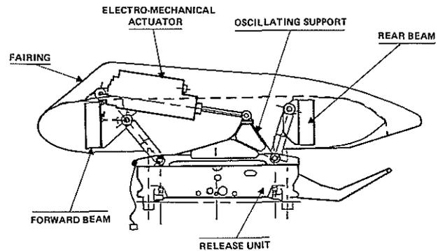
Fig. 6 : ELEVATION - SLAVING SYSTEM MOUNTED AT THE END OF WEAPON POD
