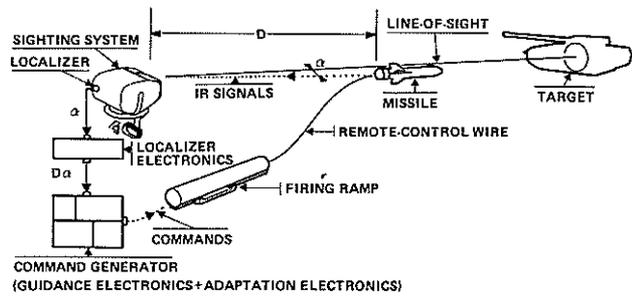
Fig. 12 : HOT MISSILE GUIDANCE PRINCIPLE
