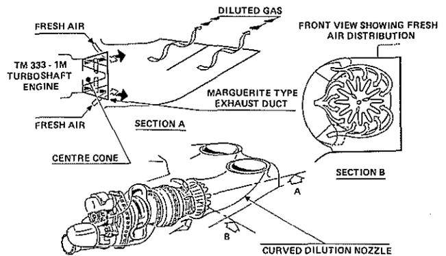
Fig. 17 : EXHAUST GAS DILUTER
