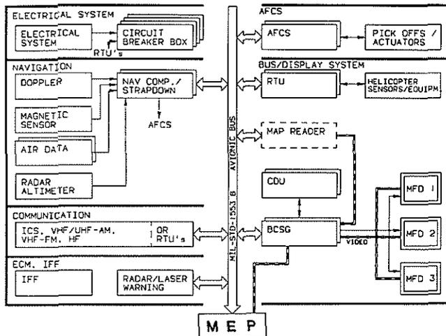
Fig. 5 : BASIC HELICOPTER SYSTEM ARCHITECTURE
