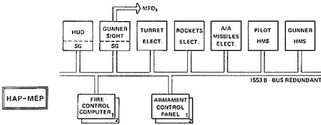
Fig. 7. ATTACK AND GROUND SUPPORT VERSION SYSTEM ARCHITECTURE
