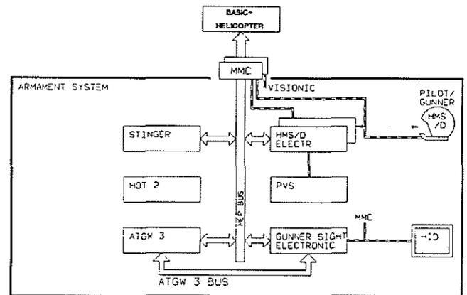
Fig. 6 : EUROMEP SYSTEM ARCHITECTURE
