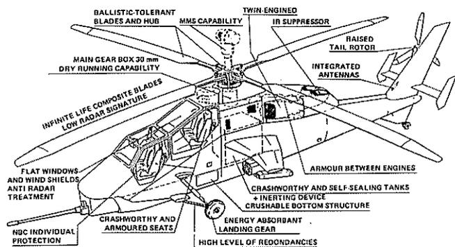
Fig. 17 : PASSIVE MEASURES TO MINIMIZE VULNERABILITY HAP-PAH/HAC
