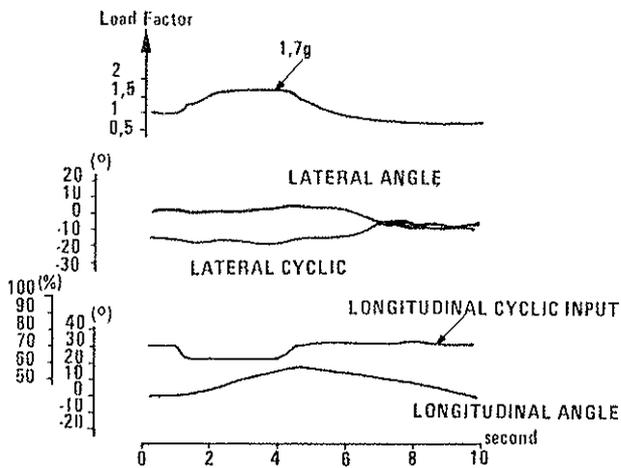
Fig. 20 : UNCOUPLING OF CONTROLS
