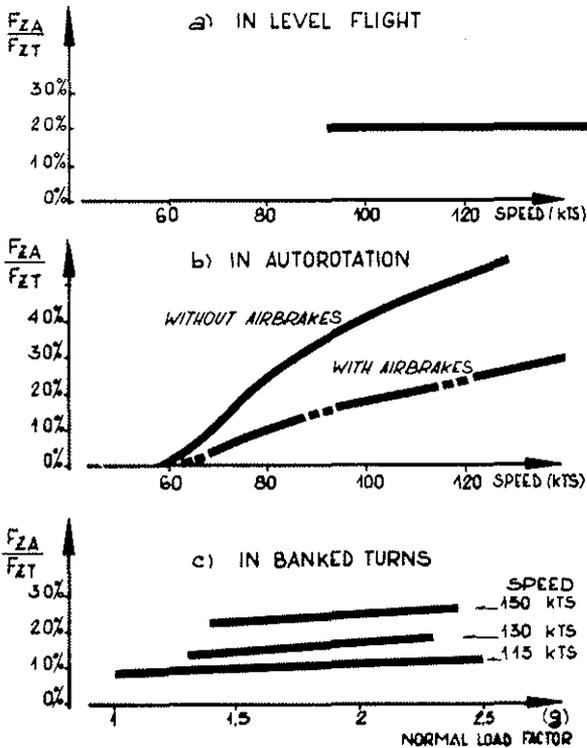
FIG 9 : WING LIFT, IN PERCENT OF TOTAL LIFT
