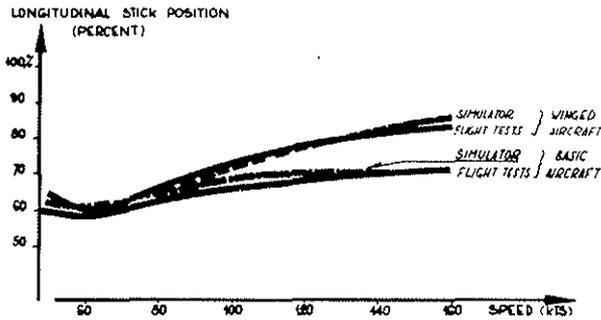
FIG 8 : STATIC SPEED STABILITY AT CONSTANT COLLECTIVE PITCH (13°)
