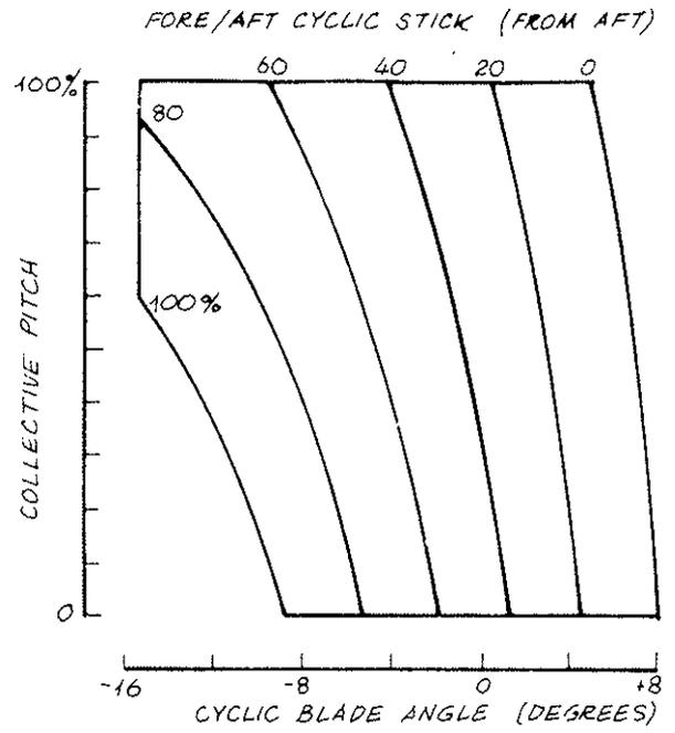
FIG. 5 TYPICAL COLLECTIVE/CYCLIC CONTROL INTERLINKAGE
