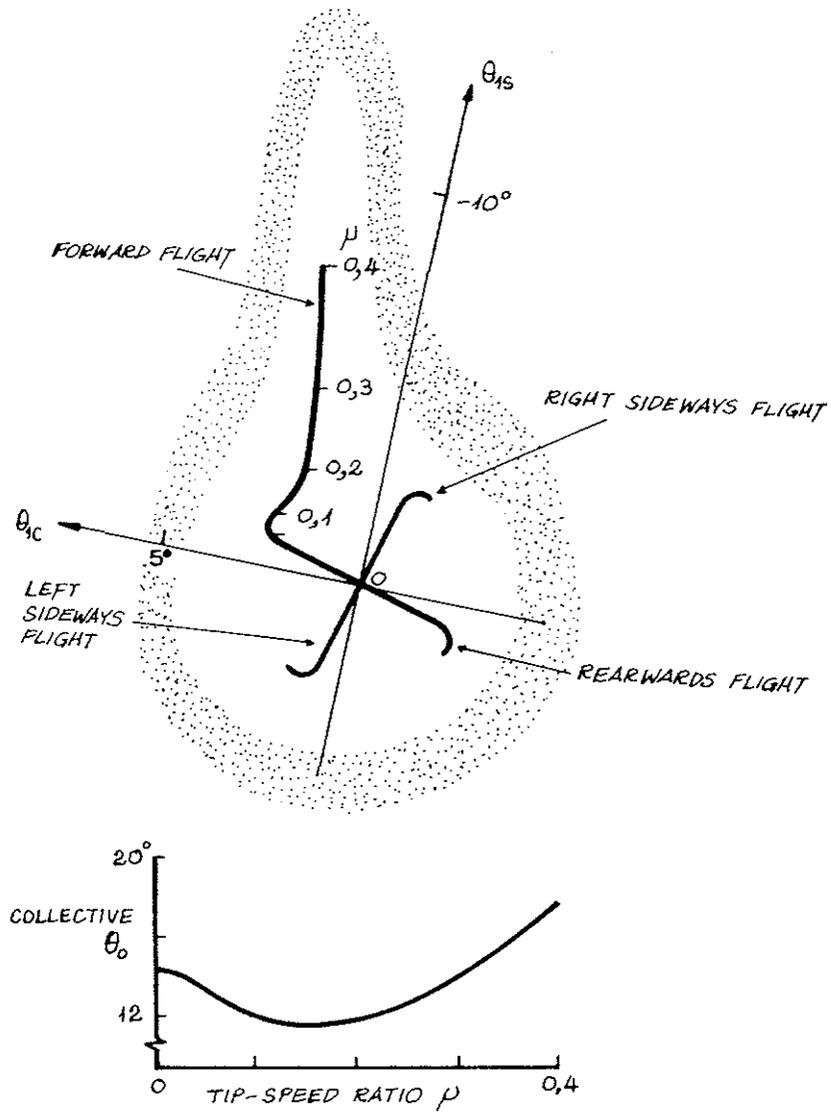
FIG. 3 ROTOR CONTROL REQUIREMENTS
