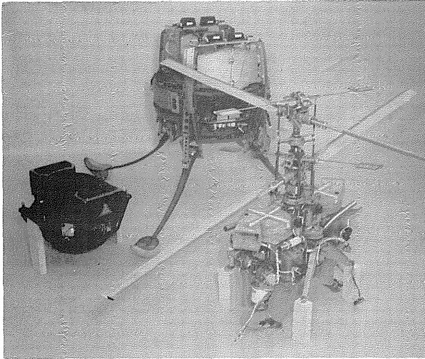
**FIG. 8 WIDEYE MODULAR CONSTRUCTION**
