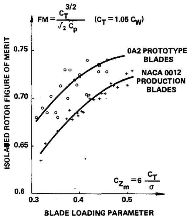
Figure 12 : ROTOR EFFICIENCY COMPARISON FROM FLIGHT TESTS
