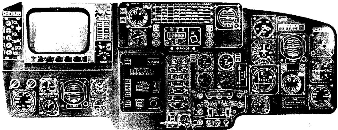
Fig. 8 : SA 365 F - INSTRUMENT PANEL (AS 15 VERSION)
