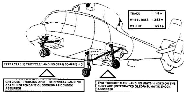
Fig. 5 : SA 365 N - LANDING GEAR
