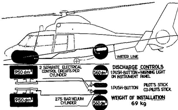
Fig. 11 : SA 365 N - EMERGENCY FLOATION GEAR
