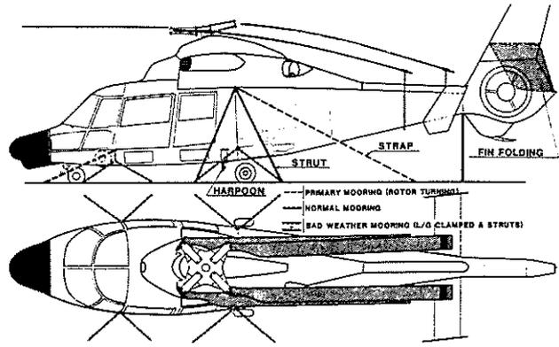
Fig. 6 : SA 365 F - MOORING FOLDING INSTALLATION
