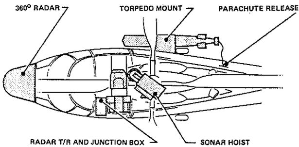
Fig. 14 : SA 365 F - SONAR INSTALLATION
