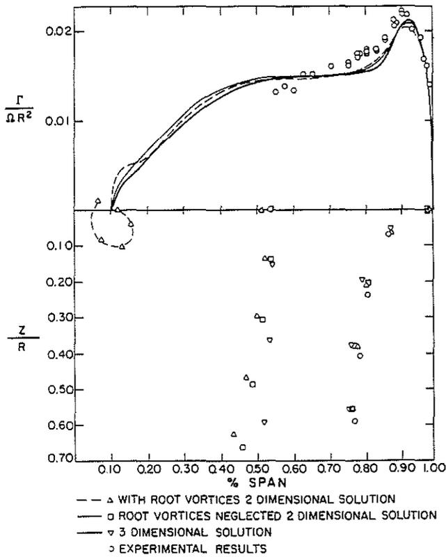
FIG. 3: BLADE BOUND CIRCULATION DISTRIBUTION AND LOCATION OF VORTICES IN WAKE FOR TWO BLADED ROTOR OF REF. 17.
