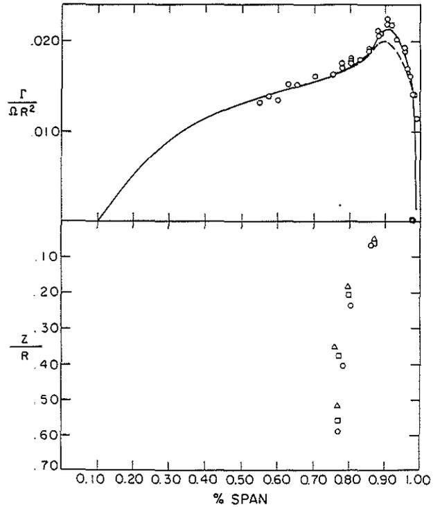
FIG. 4: BLADE BOUND CIRCULATION DISTRIBUTION AND LOCATION OF VORTICES IN WAKE FOR TWO BLADED ROTOR OF REF. 17.
