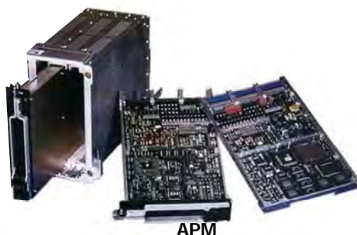
Figure 7: Autopilot Module APM2020 (Sagem)
