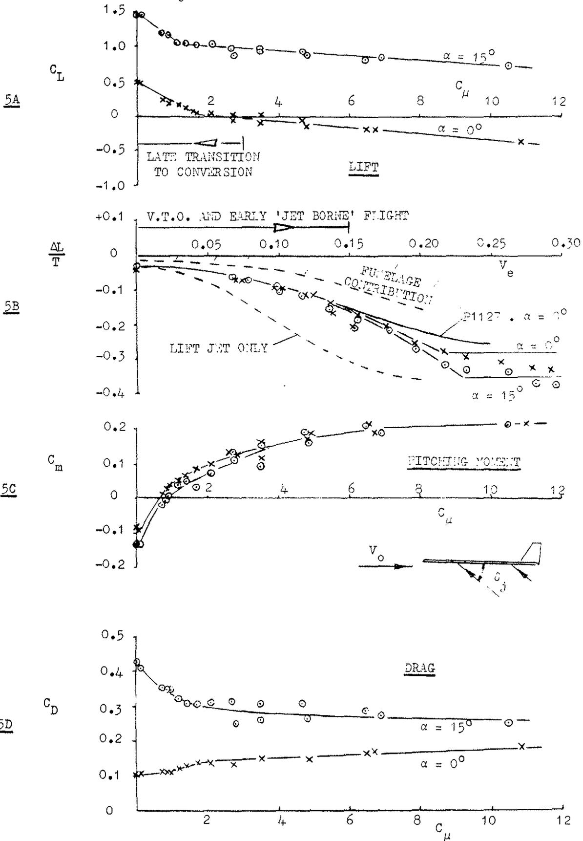
**FIG. 6 POWER ON. FORWARD SPEED. IN GROUND EFFECT**
