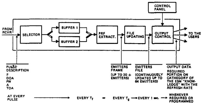
Fig. 8 - AUTOMATIC EXTRACTOR STRUCTURE
