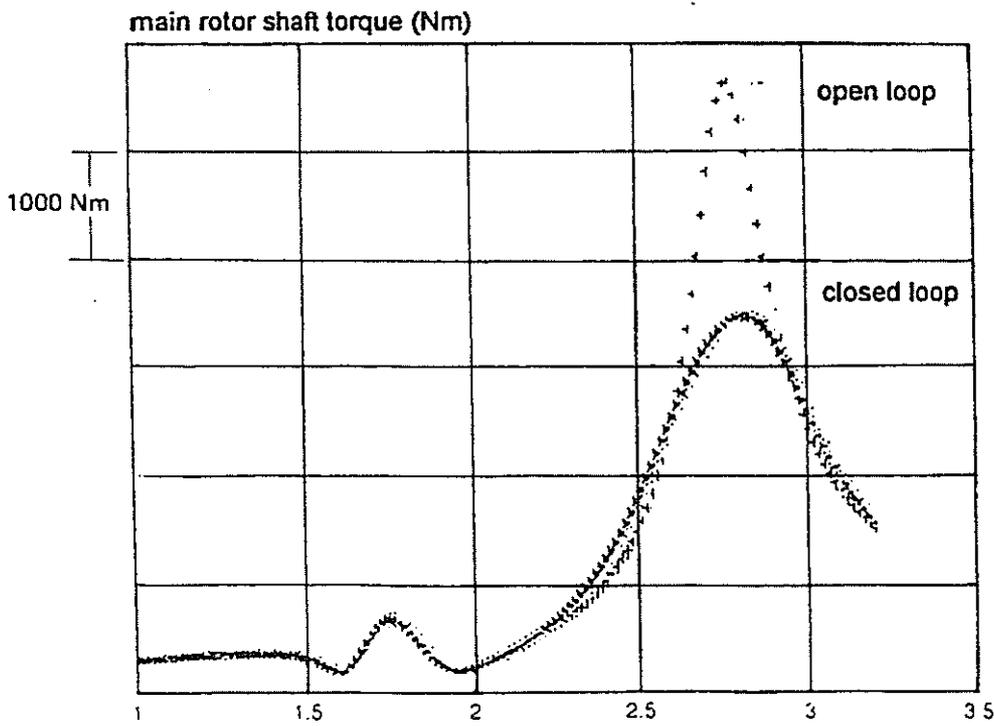
**Fig. 9: SUPER PUMA MK2 - ACTIVE CONTROL OF DRIVE TRAIN**
