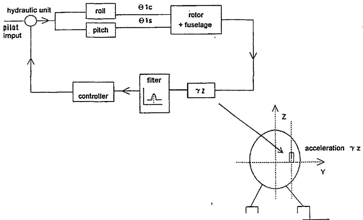
**Fig. 2: ACTIVE GROUND RESONANCE CONTROL LOOP**
