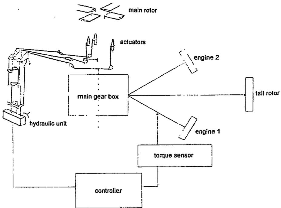
**Fig. 8: DRIVE TRAIN ACTIVE CONTROL LOOP**
