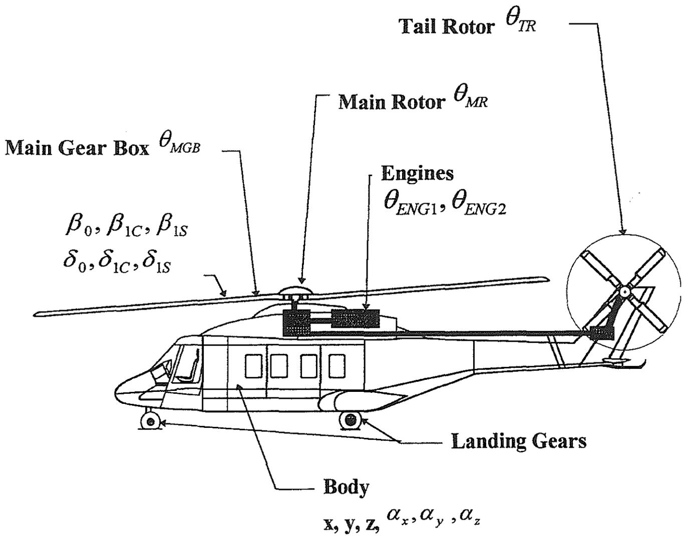
**Fig. 1: AEROMECHANICAL STABILITY MODELING**
