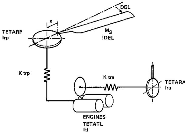
FIG. 1 : THEORETICAL MODEL OF THE DRIVE SYSTEM
