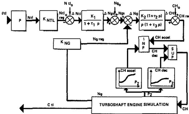
FIG. 4 : ARRIEL GOVERNING SYSTEM SCHEMATIC DIAGRAM
