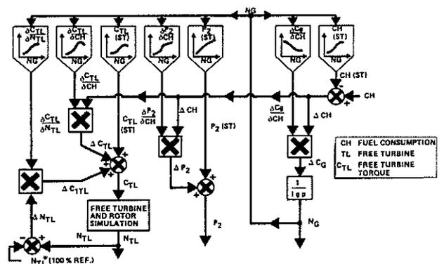
FIG. 3 : ARRIEL 1C - TURBOSHAFT ENGINE SIMULATION
