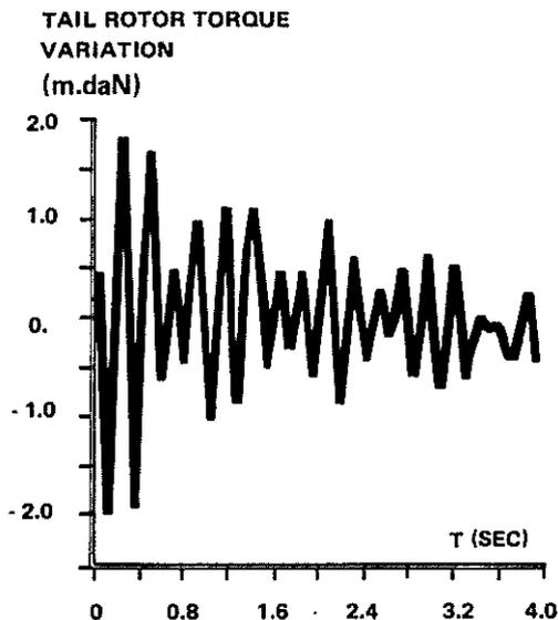
FIG. 6 : TORQUE OSCILLATION ON TAIL ROTOR TRANSMISSION MEASURED IN FLIGHT.
