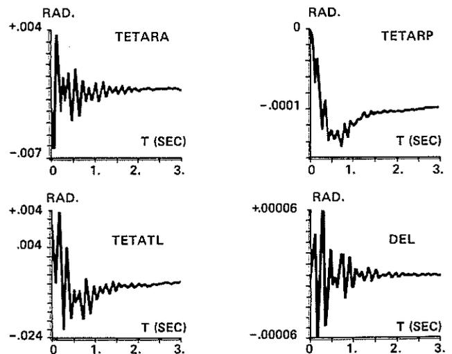
FIG. 7 : SYSTEM RESPONSE AT A GIVEN TAIL ROTOR TRANSMISSION TORQUE STEP
