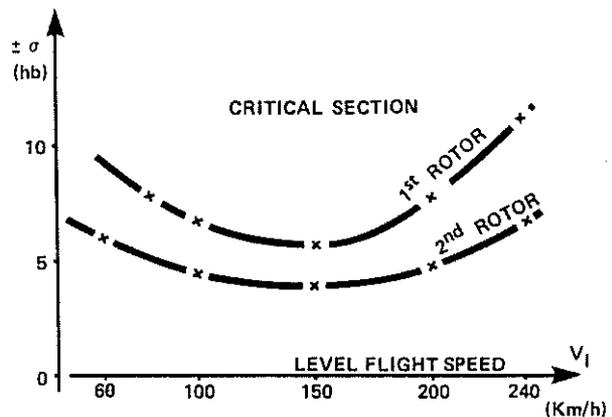
Fig. 12 : FOUR BLADED FLEXBEAM : CRITICAL STRESSES VERSUS FLIGHT SPEED
