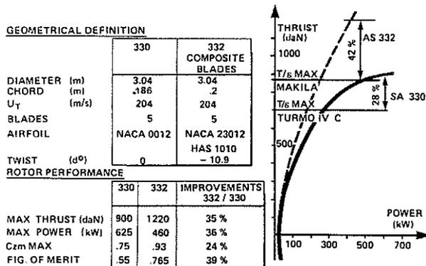
Fig. 5 : TAIL ROTOR PERFORMANCE SA 330 / AS 332
