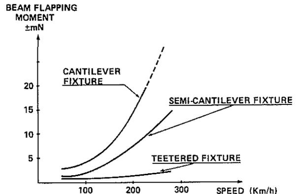
Fig. 16 : TWO BLADED-FLEXBEAM FLAPPING MOMENT.
