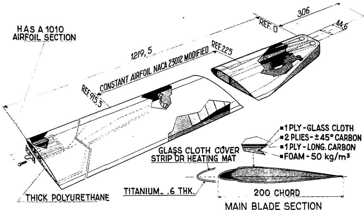
Fig. 18 : AS 332 COMPOSITE BLADE TECHNOLOGY
