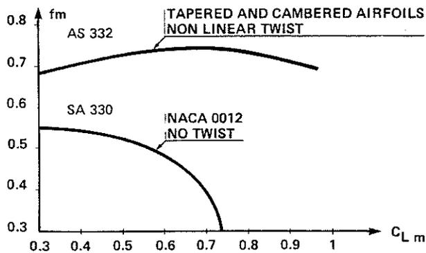
Fig. 4 : TAIL ROTOR FIGURE OF MERIT
