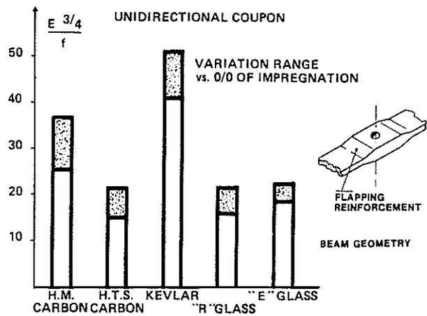
Fig. 11 : FLEXBEAM STRENGTH CHARACTERISTICS  $\frac{E^{3/4}}{f}$ , BLADE SHAPE
