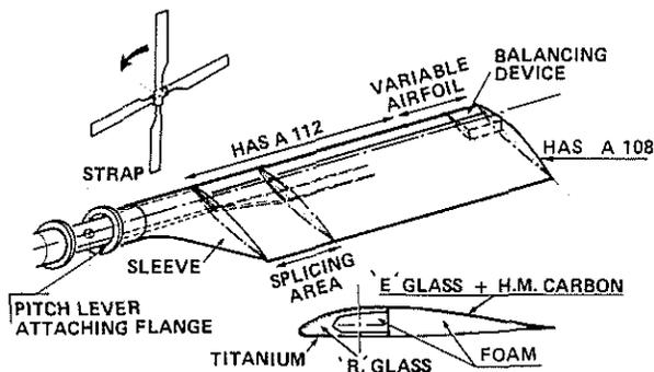
Fig. 19 : FOUR BLADED FLEXBEAM ROTOR TECHNOLOGY
