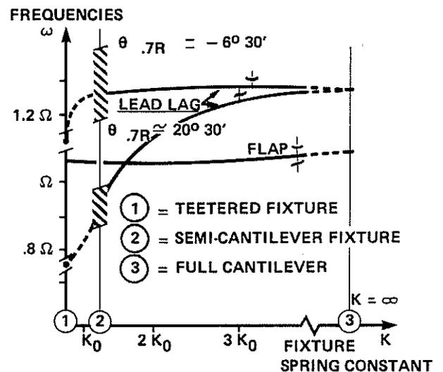
Fig. 10 : FIXTURE SPRING EFFECT ON TWO BLADED FLEXBEAM N.F.
