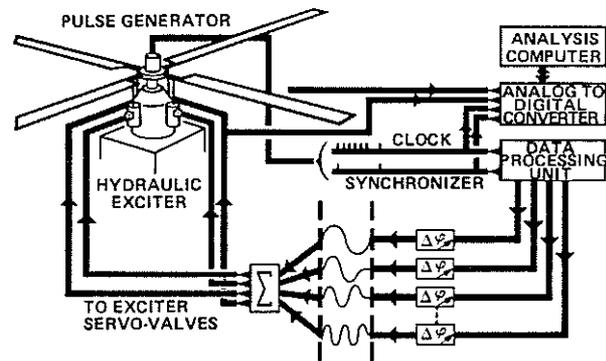
Fig. 6 : DYNAMIC TESTS ON WHIRL TEST STAND
