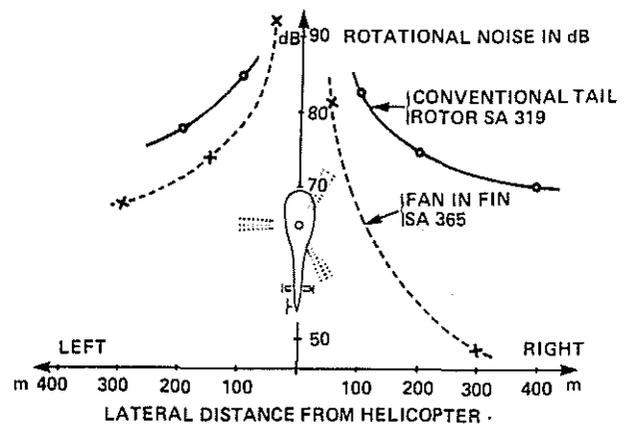
Fig. 28 : EXTERNAL NOISE COMPARISON : TAIL ROTOR / FAN-IN-FIN
