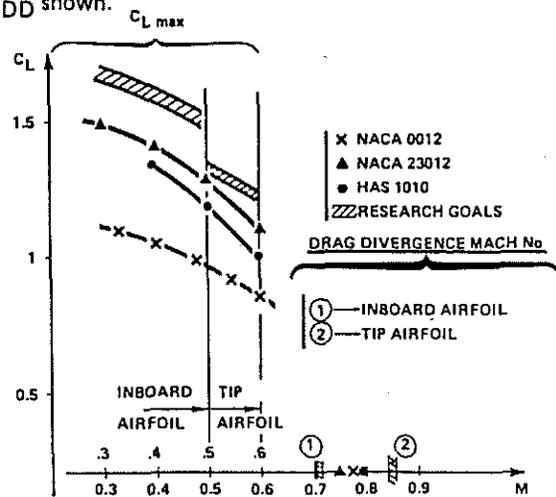
Fig. 2 : AIRFOIL SECTION AERODYNAMIC CHARACTERISTICS
