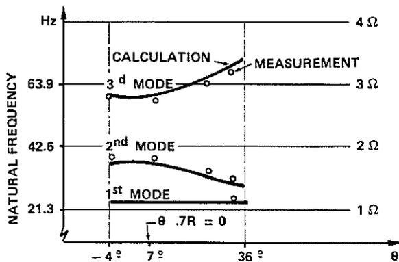
Fig. 9 : FIVE BLADED ROTOR NATURAL FREQUENCIES. COMPUTATION/TEST
