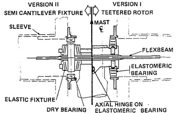
Fig. 21 : TWO BLADED FLEXBEAM HUB PRINCIPLES
