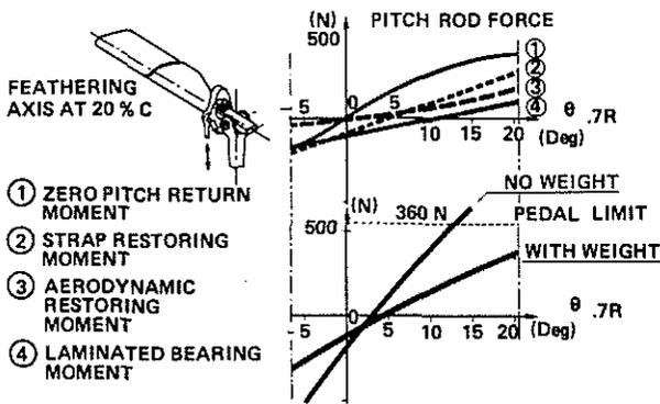
Fig. 17 : CONTROL FORCES ON THE TWO BLADED FLEXBEAM ROTOR
