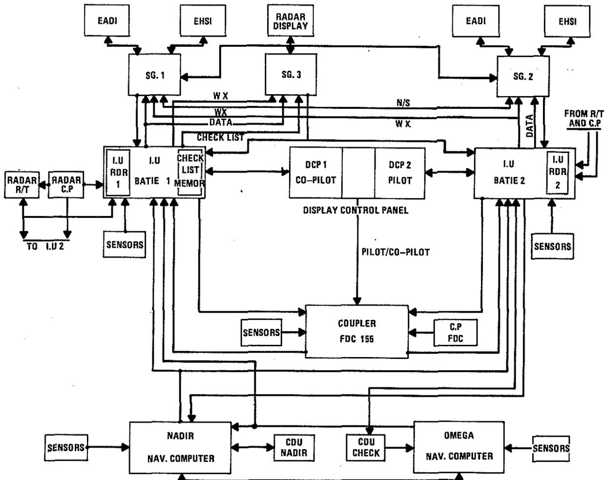
Fig. 12 SA 365 F SAR SYSTEM INTERCONNECTION MULTIFUNCTION DISPLAY CONFIGURATION
