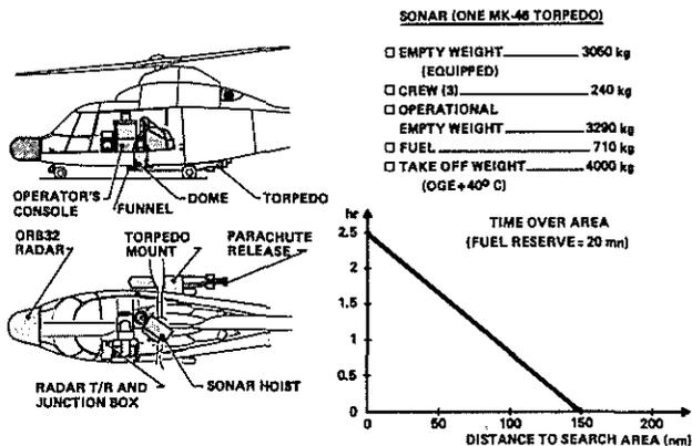
Fig. 26 SONAR - TORPEDO
