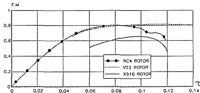
FIGURE 17 : COMPARISON BETWEEN TILT ROTORS
