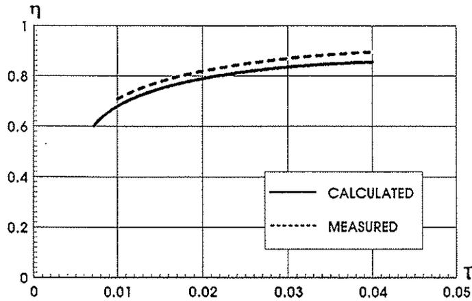
FIGURE 12 : EFFICIENCY AT  $M = 0.5$  VERSUS THRUST COEFFICIENT
