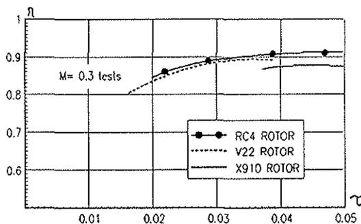
FIGURE 18 : COMPARISON BETWEEN TILT ROTORS
