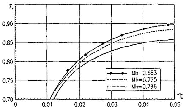
FIGURE 15 : CALCULATED EFFICIENCIES VERSUS THRUST COEFFICIENT
