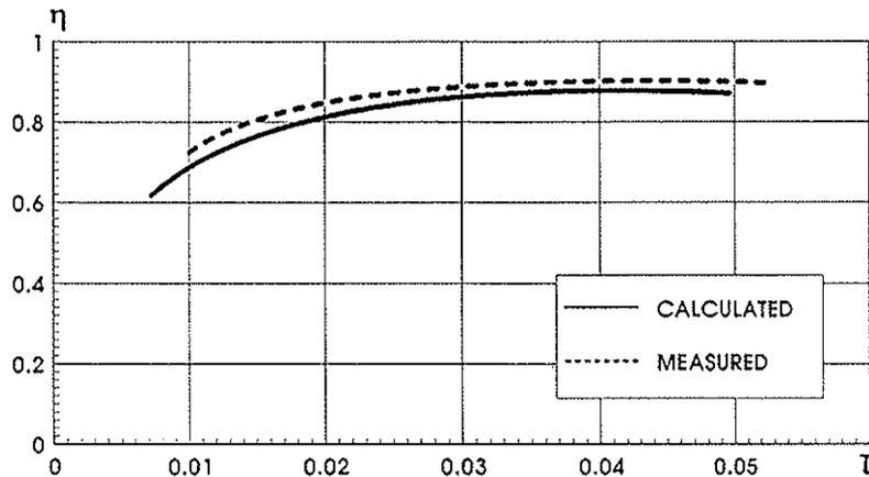
FIGURE 13 : EFFICIENCY AT  $M = 0.3$  VERSUS THRUST COEFFICIENT
