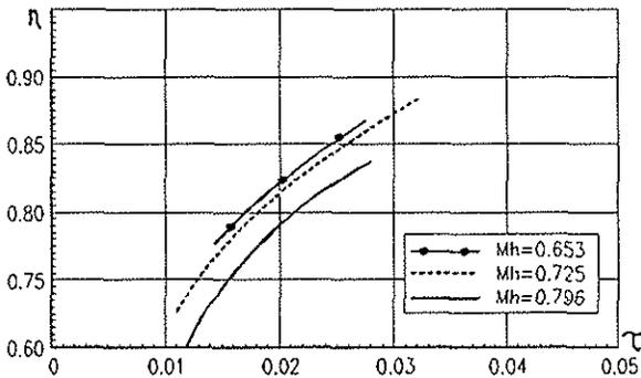
FIGURE 14 : MEASURED EFFICIENCIES VERSUS THRUST COEFFICIENT
