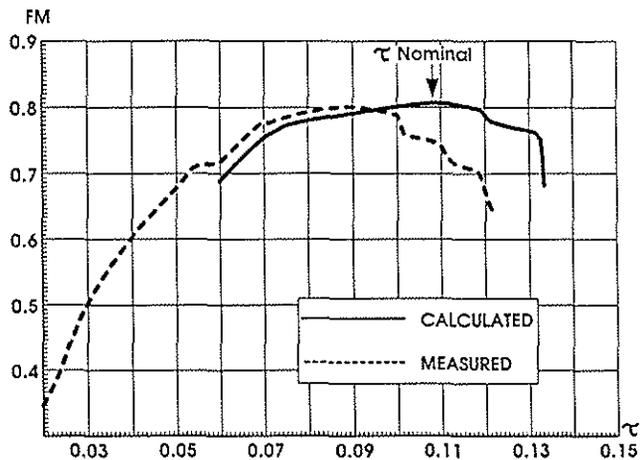
FIGURE 9 : RC4 ROTOR IN HOVER
