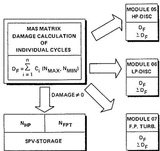
$D_F$  = CYCLE CONSUMPTION (DAMAGE) PER FLIGHT
