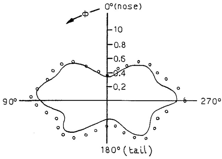
MEASURED ——— COMPUTED ○ ○ ○ FREQUENCY = 41.75 MHz
