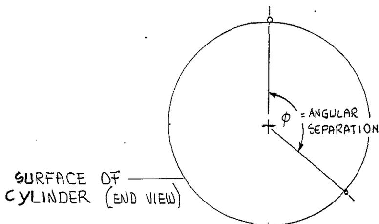
FIG. 7 MONOPOLE ANTENNAS ON A CIRCULAR CYLINDER -
