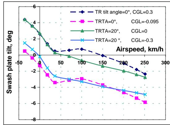
Fig. 20. MI-8 swash-plate tilt vs. airspeed
