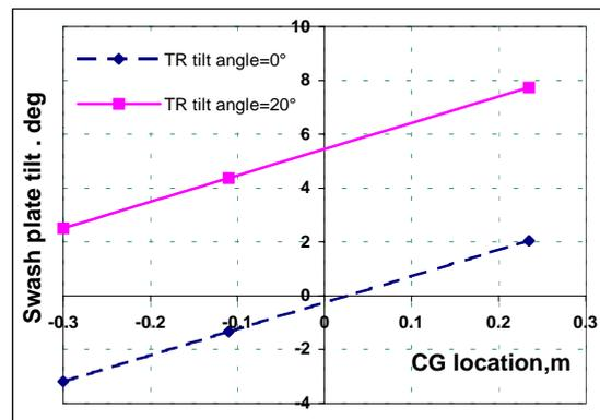
**Fig. 19. Mi-24 swash-plate tilt vs. CG location**
