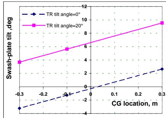
**Fig. 18. MI-8 swash-plate tilt vs. CG location**
