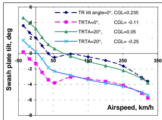
Fig. 21. MI-24 swash-plate tilt vs. airspeed
