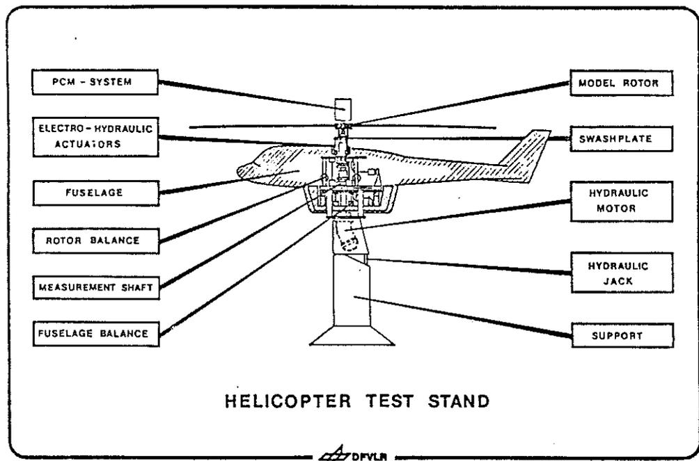
Figure 1. DFVLR-Rotor Test Stand
