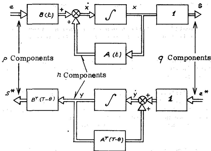
FIGURE 8 - SIMULATION OF SELF-ADJOINT MODIFIED SYSTEM
