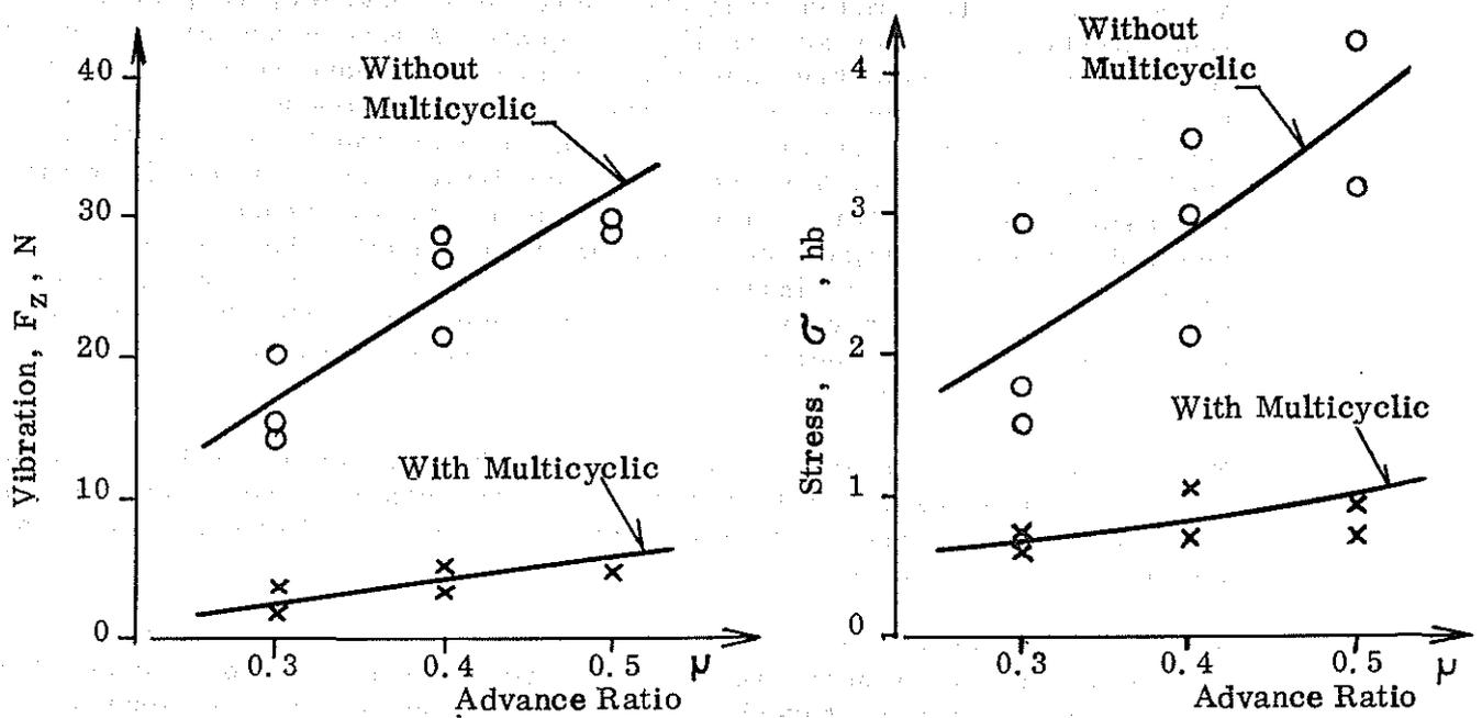
FIGURE 11 - EXPANSION OF FLIGHT ENVELOPE.
