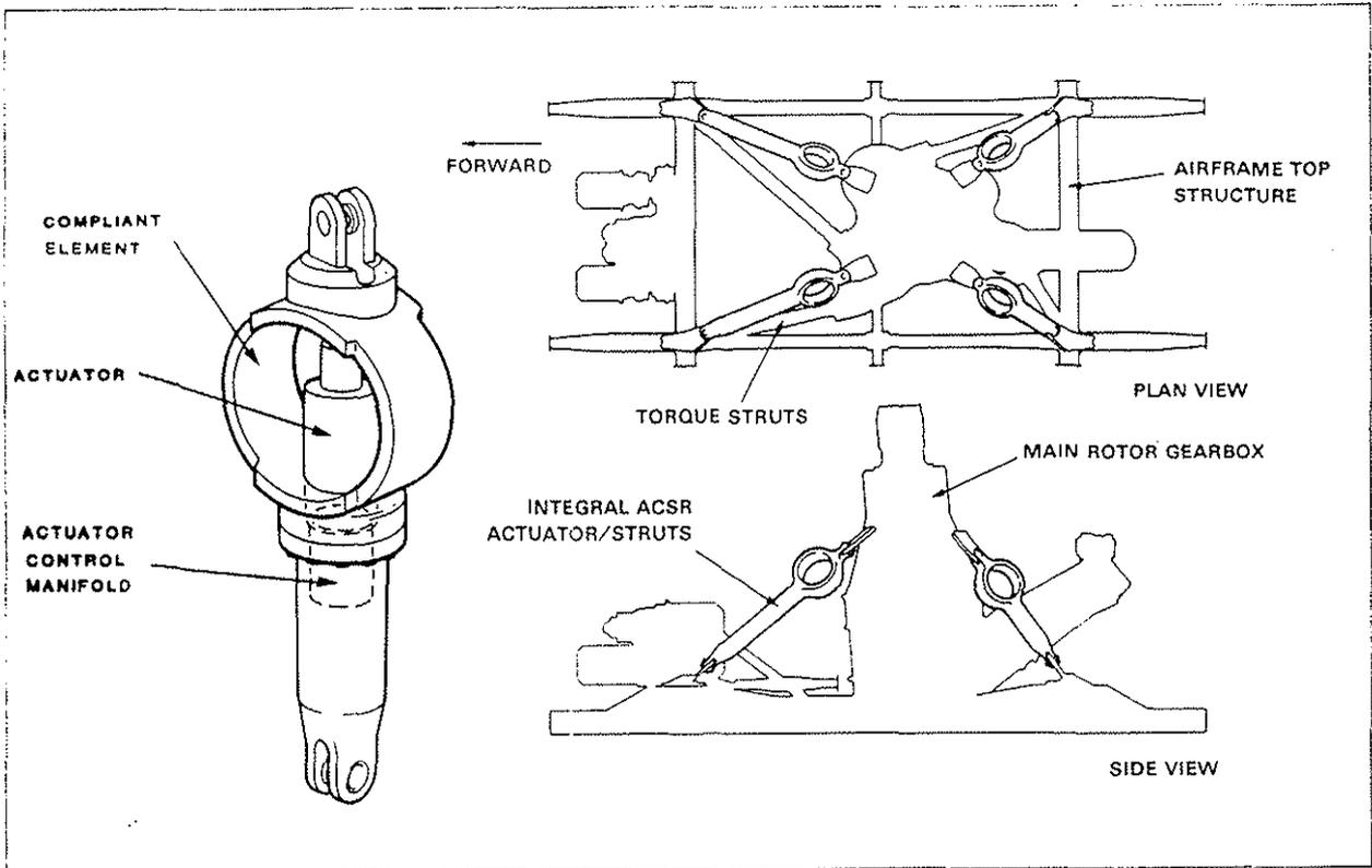
FIGURE 3 : EH101-ACSR INTEGRAL STRUT/ACTUATOR AND CONFIGURATION
