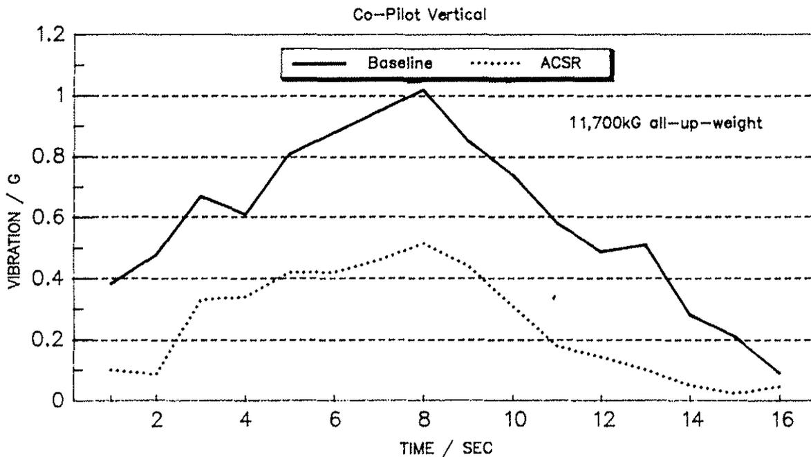
FIGURE 8 : EH101-ACSR FLIGHT TESTS - TRANSITION-TO-HOVER
