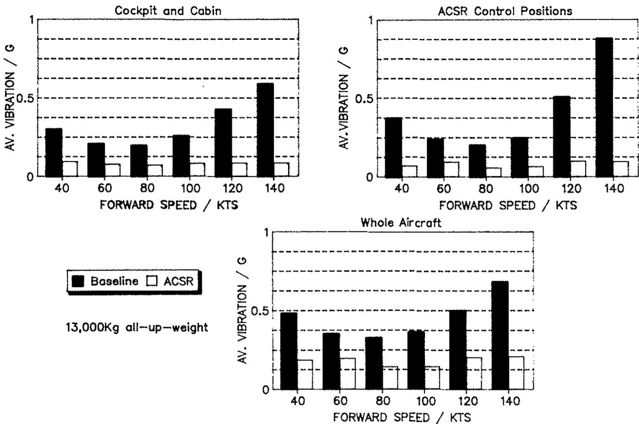
FIGURE 6 : EH101-ACSR FLIGHT TESTS -- VIBRATION AVS VS FWD SPEED
