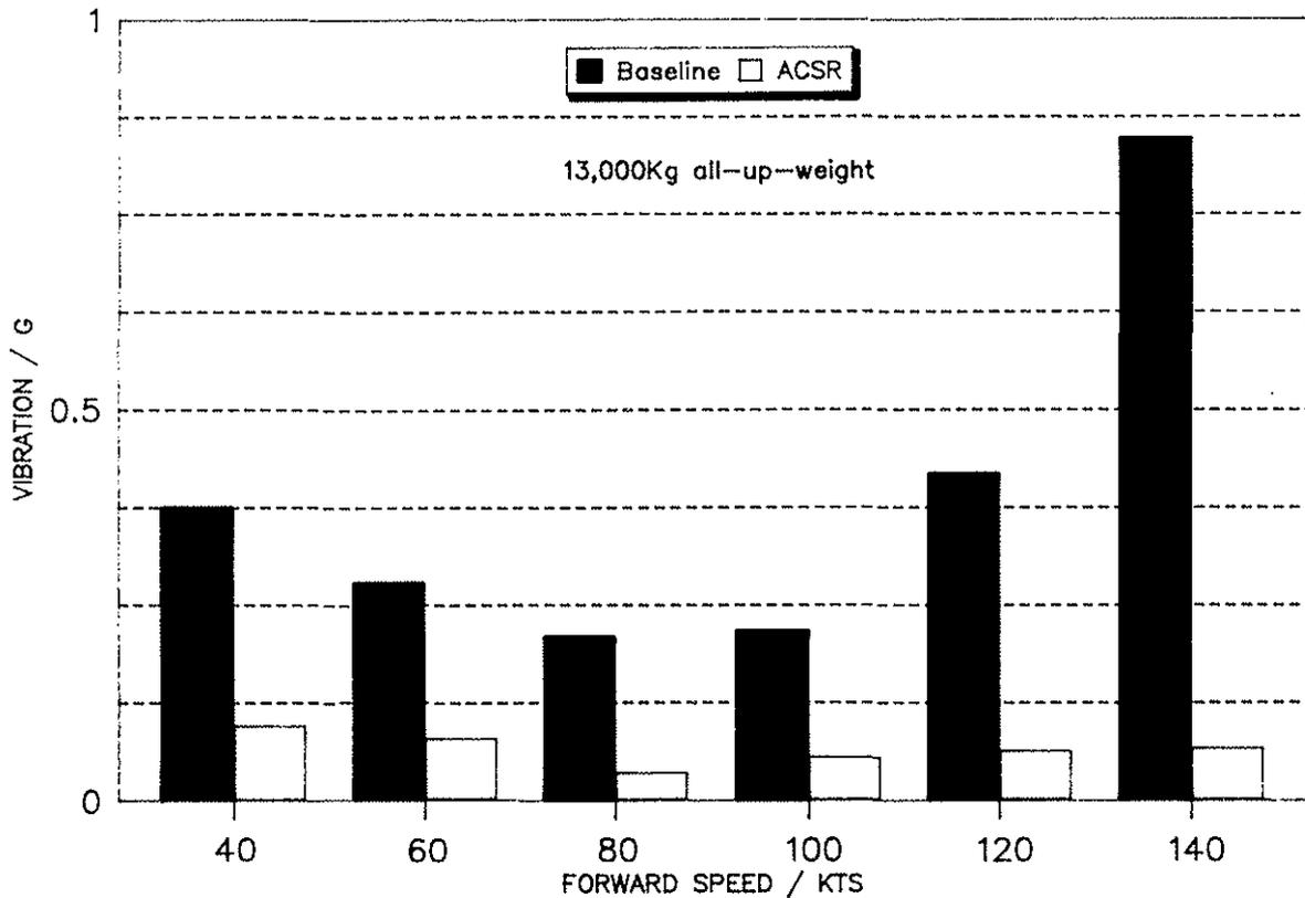
FIGURE 5 : EH101-ACSR FLIGHT TESTS -- CO-PILOT VERT VIBRATION VS FWD SPEED
