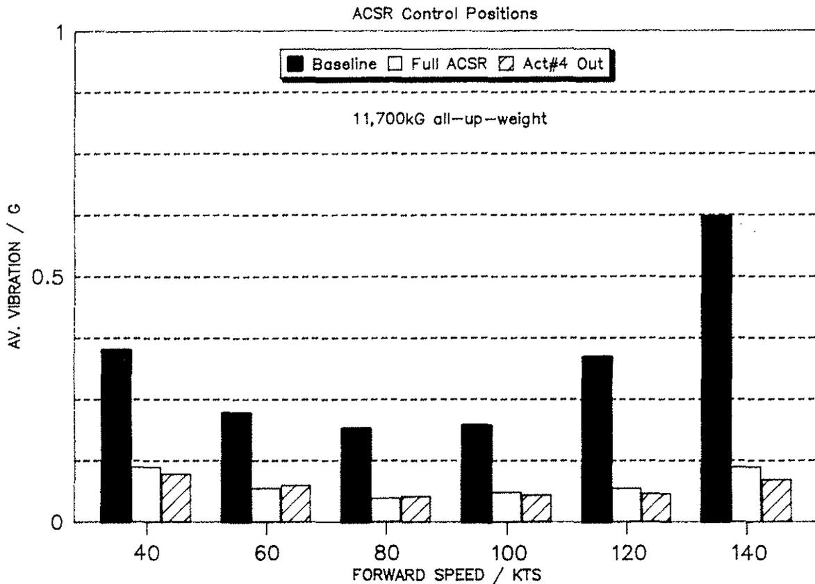
FIGURE 7 : EH101-ACSR FLIGHT TESTS - AV. VIBRATION VS FWD SPEED FOR OPTIMUM 3-ACTUATOR CONFIG (#4=AFT STBD)
