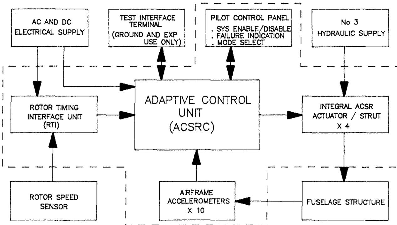
FIGURE 2 : EH101-ACSR SYSTEM INSTALLATION SCHEMATIC
