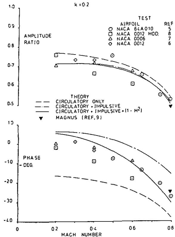
FIG. 4 OSCILLATORY DATA COMPARISON
