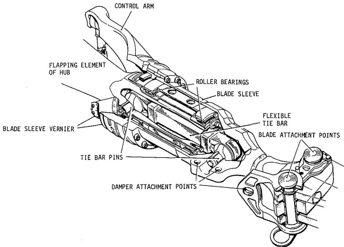
FIG.5. MAIN ROTOR HEAD
