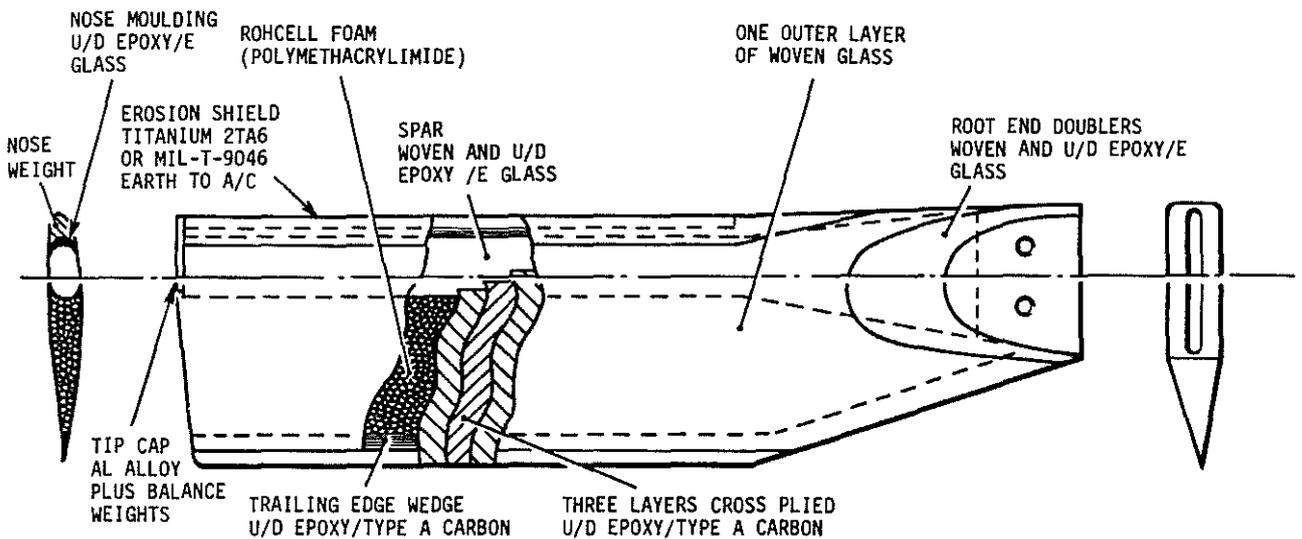
FIG.11. TAIL ROTOR BLADE
