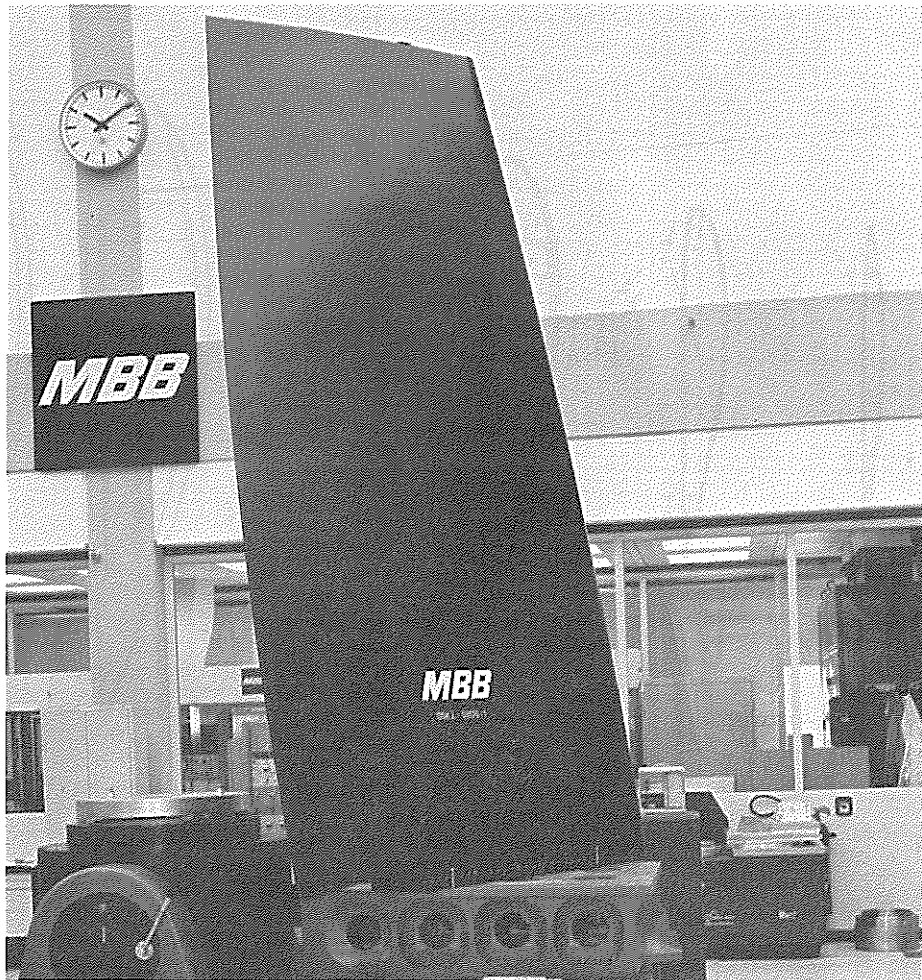
Figure 1: Rotor Blade of the Deutsch-Niederländischer Windkanal (DNW) Shaker Tested
