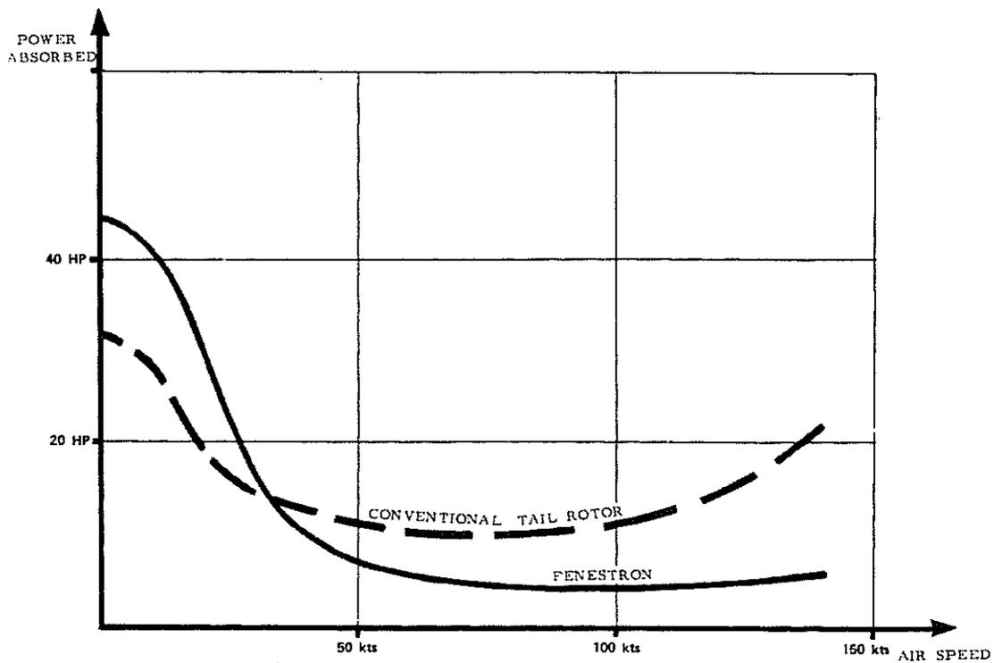
13. COMPARISON OF POWER ABSORBED IN LEVEL FLIGHT
