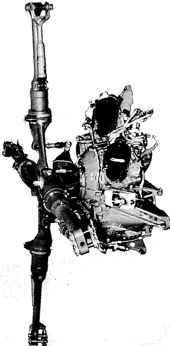
Fig. 16. Semi-rigid Rotor Head
