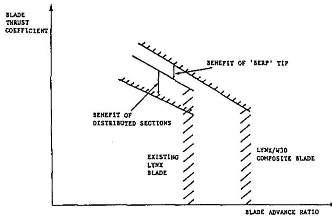
Fig. 23. Lynx/W30 Composite Blade:
