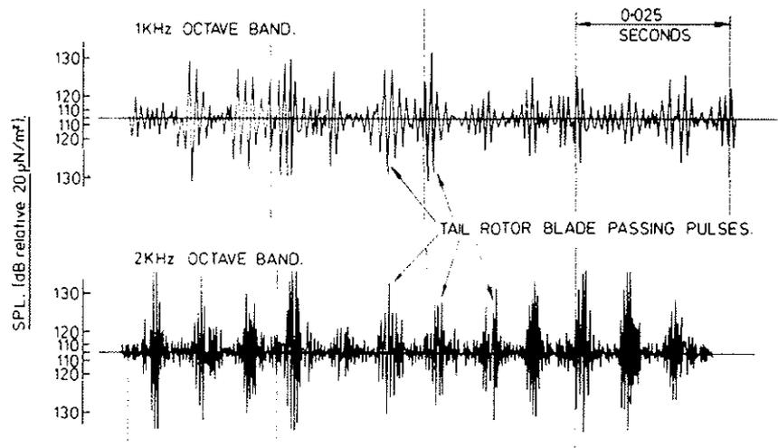
FIG. 10. U-V TIME HISTORIES FOR REVERSED TAIL ROTOR - TAIL MICROPHONE (115 KNOTS)
