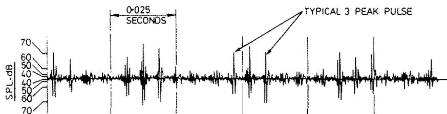
FIG. 4. dBA TIME HISTORY FOR GROUND MOUNTED MICROPHONE (TAPE SPEED REDUCED BY A FACTOR OF 4).
