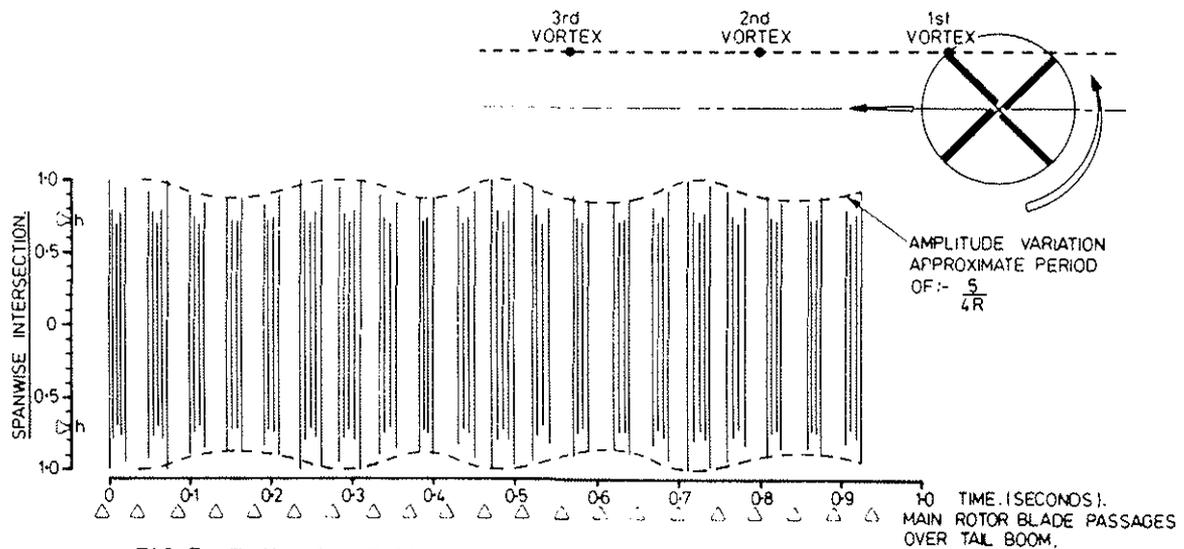
FIG. 7. TAIL ROTOR BLADE/MAIN ROTOR VORTEX INTERSECTION POINTS
