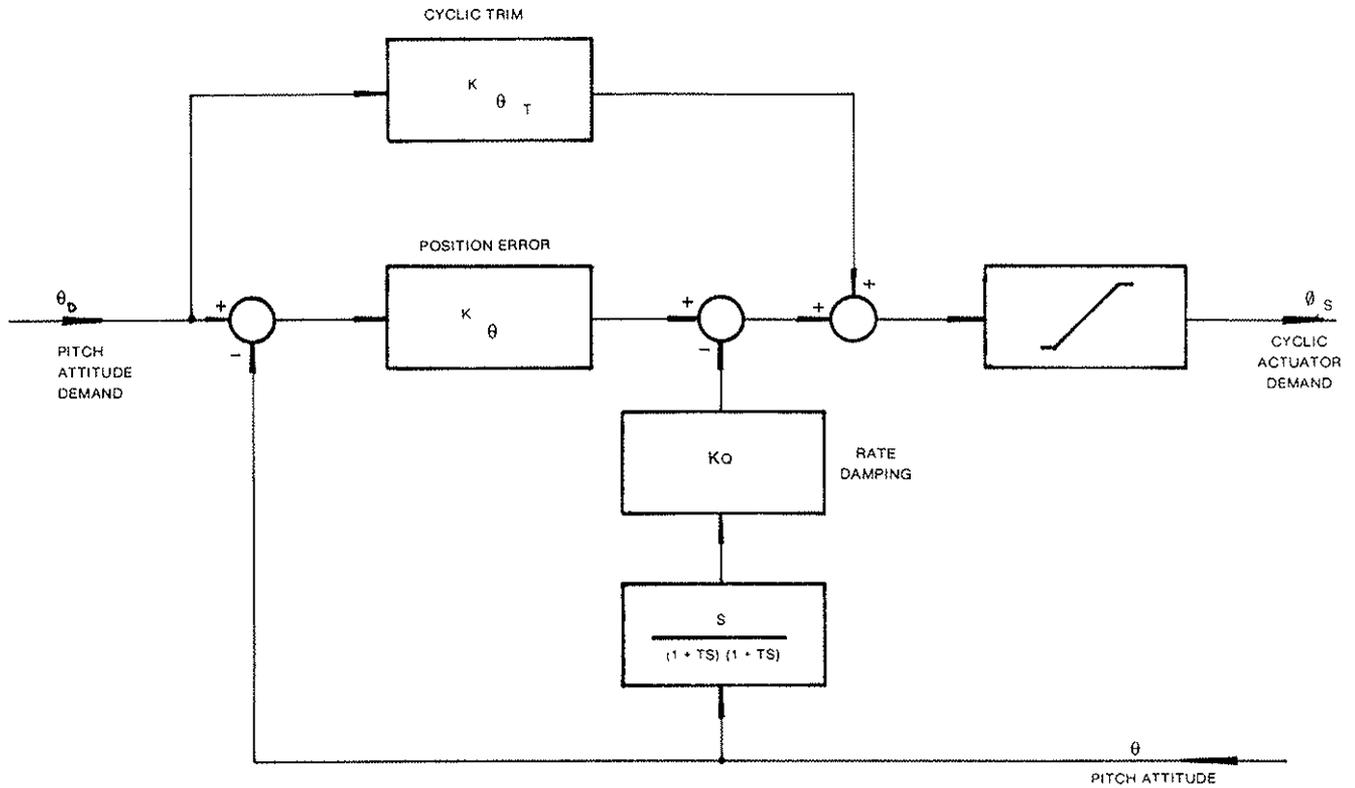
FIG.4 MOTE PITCH ATTITUDE CONTROL SYSTEM
