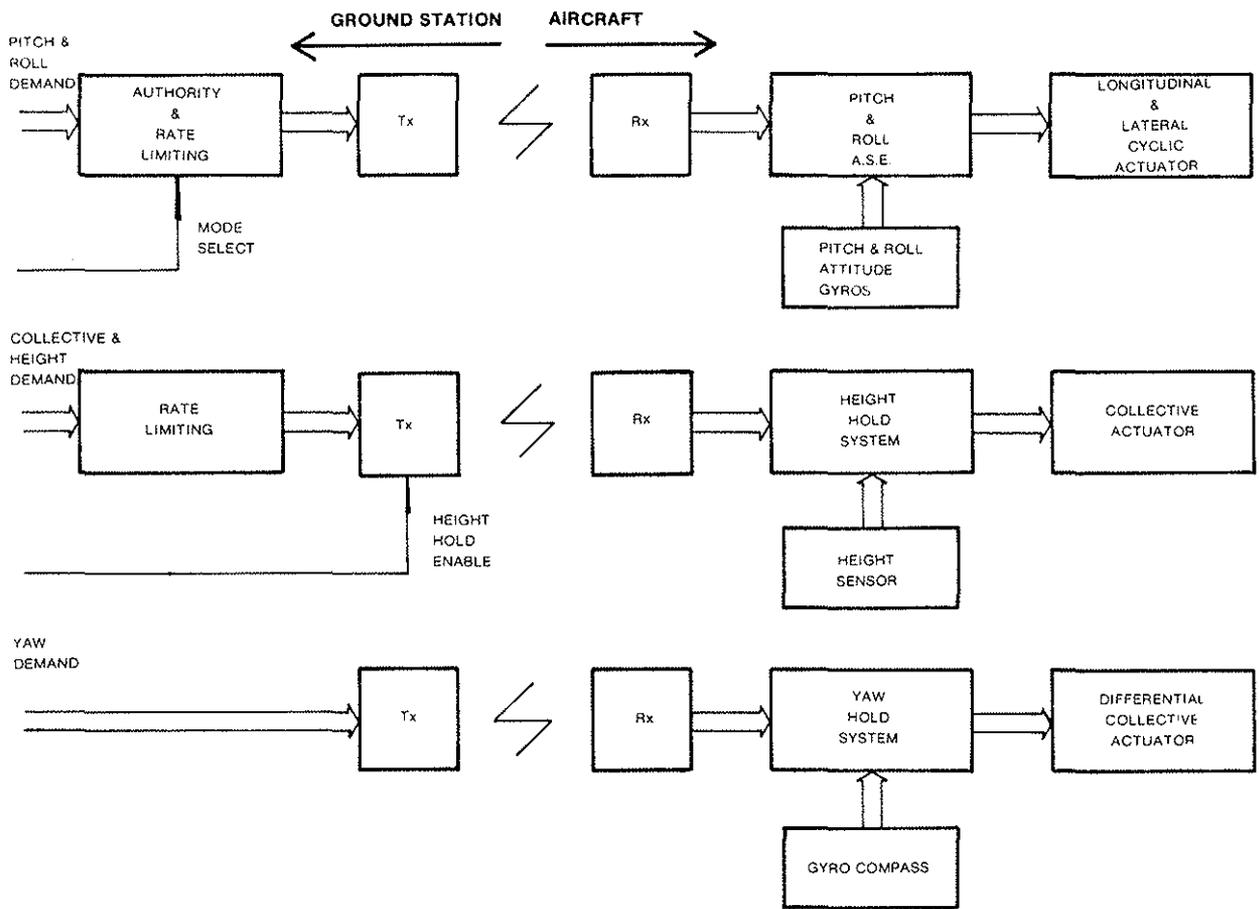
FIG.2 DIVISION OF THE FLIGHT CONTROL SYSTEM
