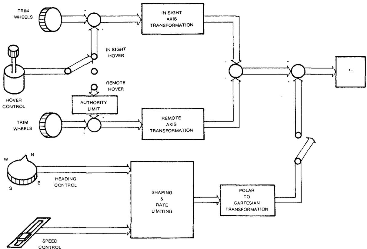
FIG.3 GROUND STATION FLIGHT CONTROL SYSTEM SCHEME
