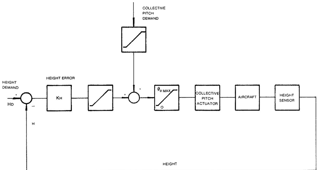
FIG. 5 HEIGHT CONTROL SYSTEM SCHEME
