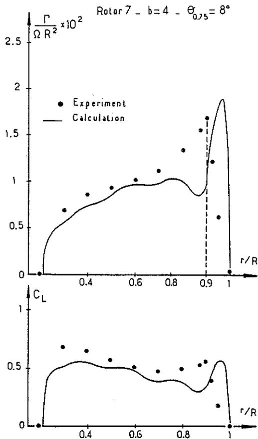
RADIAL DISTRIBUTION OF CIRCULATION AND LIFT COEFFICIENT ALONG THE BLADE
