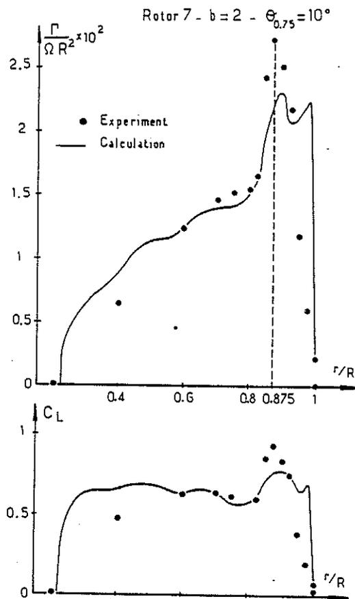
RADIAL DISTRIBUTION OF CIRCULATION AND LIFT COEFFICIENT ALONG THE BLADE
