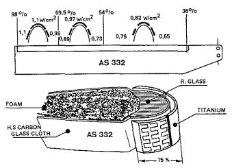
Fig. 6 : AS 332 ANTI-ICED TAIL ROTOR BLADE
