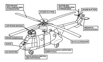
Fig. 2 : LAYOUT OF ICE PROTECTION SYSTEMS
