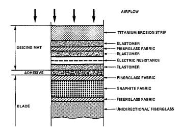
Fig. 13 : UNIDIRECTIONAL LAYOUT OF DEICING MAT
