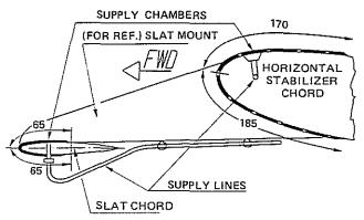
Fig. 7 : AS 332 HORIZONTAL STABILIZER PNEUMATIC DEICING
