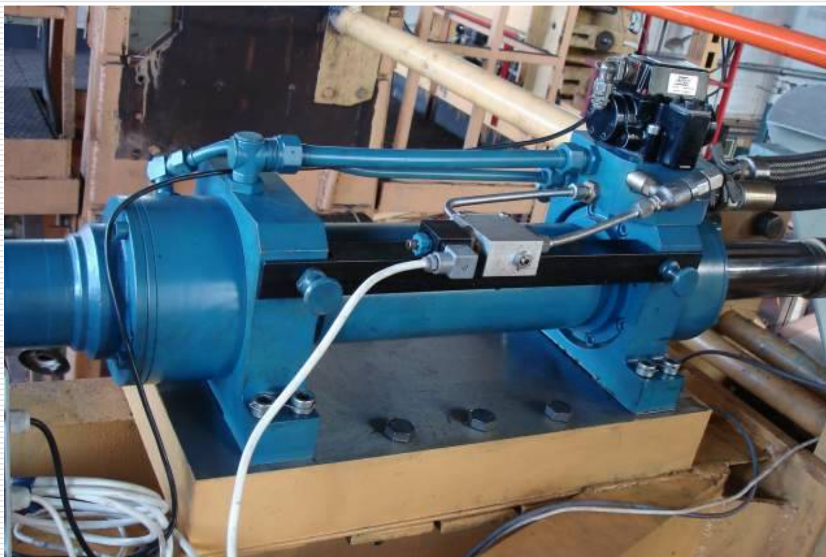
Установка гидроцилиндра на портале
