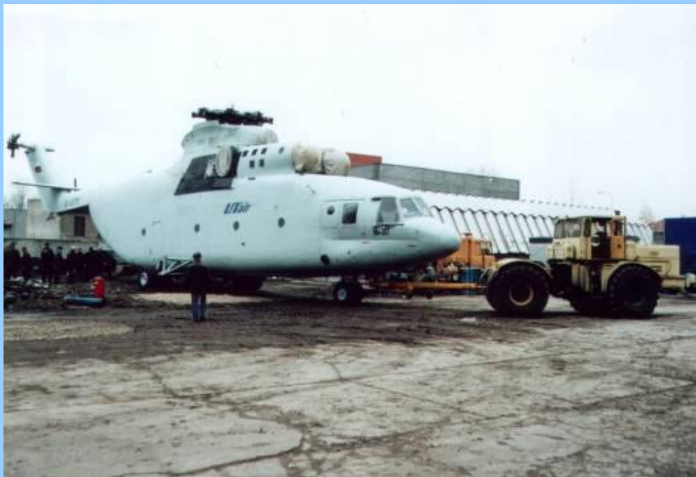
Лопасты демонтированы. Мощный Кировец буксирует объект испытаний в ангар.
