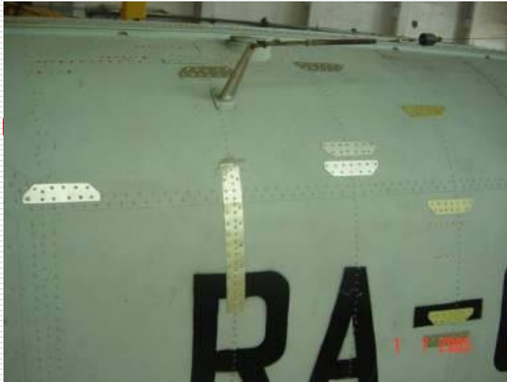
ремонтные наклейки снаружи
