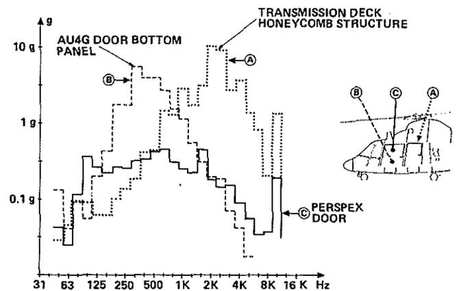
Fig. 11 VIBRATION SPECTRA ON VARIOUS PANELS FORMING THE SA 365 N, AIRFRAME CRUISE FLIGHT : 135 kt
