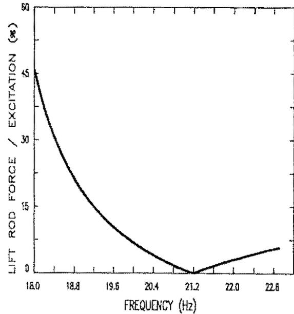
Fig. 7b : Lift Rod Loads
