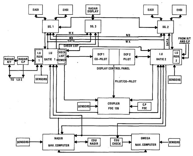
Fig. 12 SA 365 F SAR SYSTEM INTERCONNECTION MULTIFUNCTION DISPLAY CONFIGURATION
