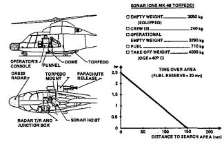
Fig. 26 SONAR - TORPEDO
