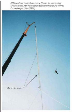
Figure 1. DERA beamform array
