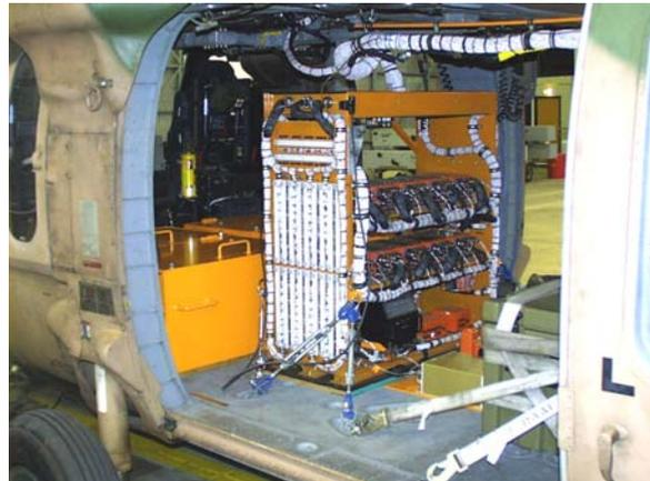
TABLE 4 - AIRFRAME STRAIN GAGES & ACCELEROMETERS
