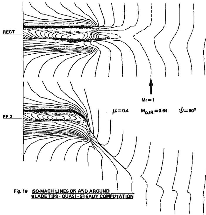
Fig. 19 ISO-MACH LINES ON AND AROUND
