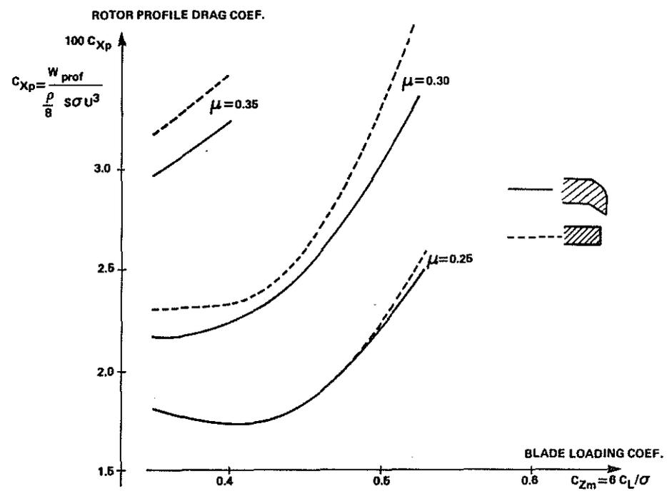
Fig. 12 **ROTOR PROFILE DRAG**
