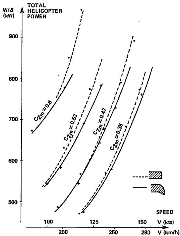
Fig. 9 **HELICOPTER PERFORMANCE IN LEVEL FLIGHT**
